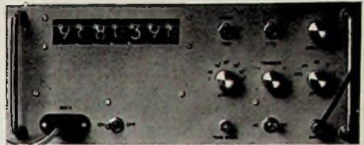
Afb. 1 – bovenaan de pagina – de geregelde VFO samen met de frequentie teller, waarmee de stabiliteitsmetingen zijn verricht.
