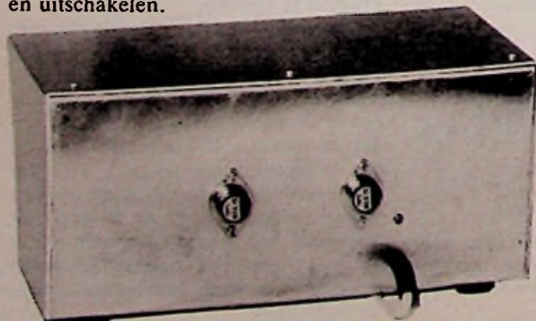
Afb. 2. Achterzijde van de kast, waarop de beide spanningregelaars geïsoleerd worden gemonteerd.
